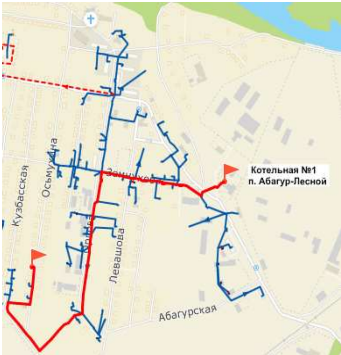
Рисунок 4.66 – Путь движения теплоносителя от источника тепловой энергии до конечного потребителя, в зоне действия котельной №1 п. Абагур-Лесной (рисунок П46.1 МУ)
