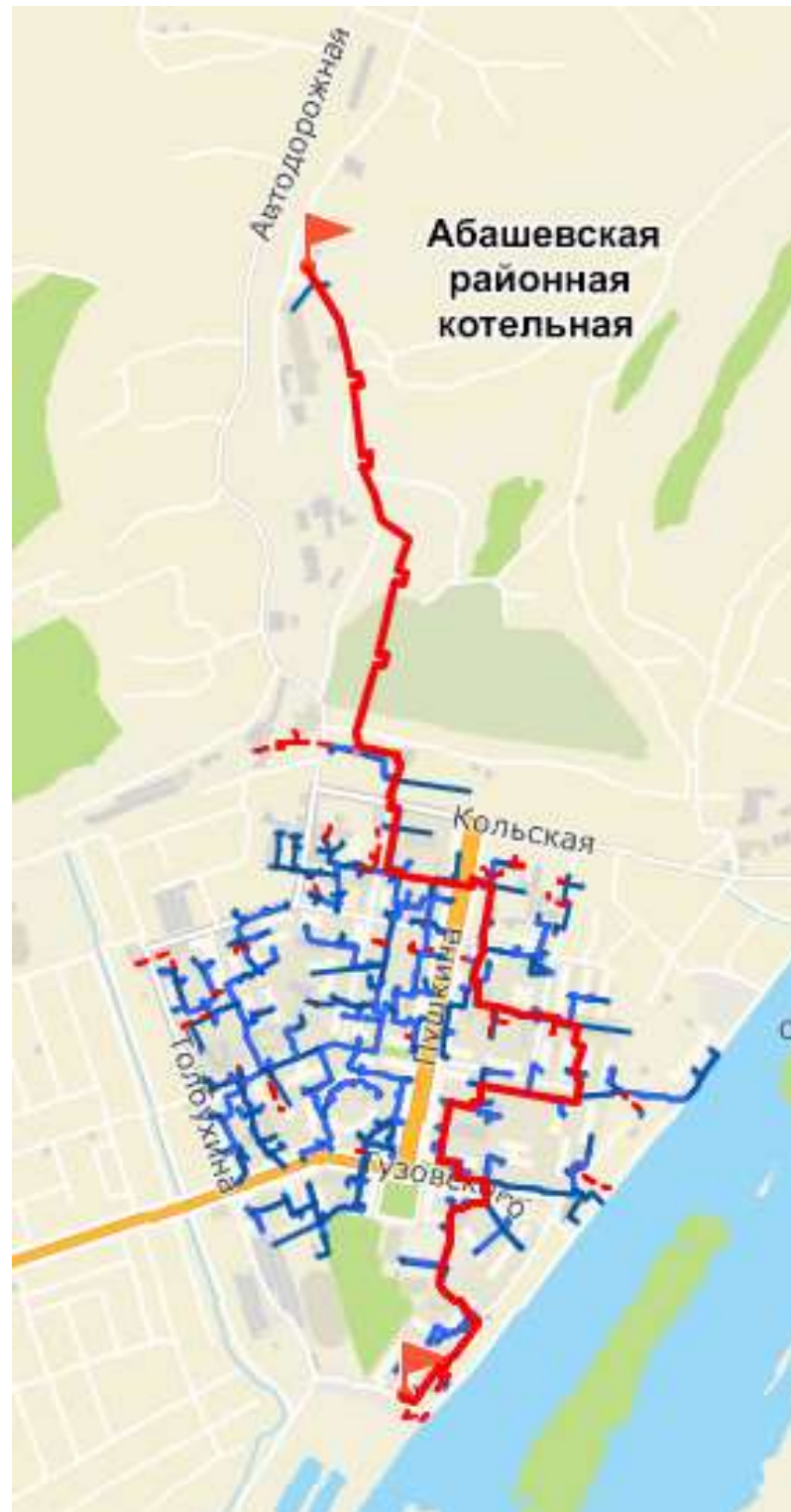
Рисунок 4.38 – Путь движения теплоносителя от источника тепловой энергии до конечного потребителя, в зоне действия Абашевской районной котельной (рисунок П46.1 МУ)
