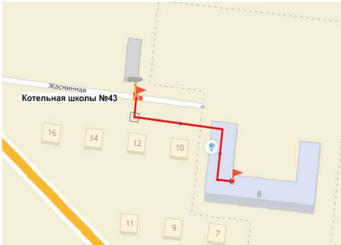
Рисунок 4.116 – Путь движения теплоносителя от источника тепловой энергии до конечного потребителя, в зоне действия котельной школы №43 (рисунок П46.1 МУ)
