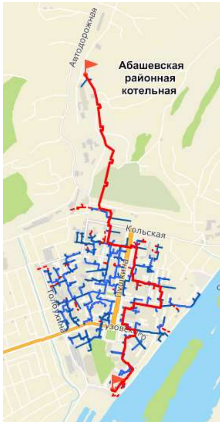
Рисунок 4.36 – Путь движения теплоносителя от источника тепловой энергии до конечного потребителя, в зоне действия Абашевской районной котельной (рисунок П46.1 МУ)
