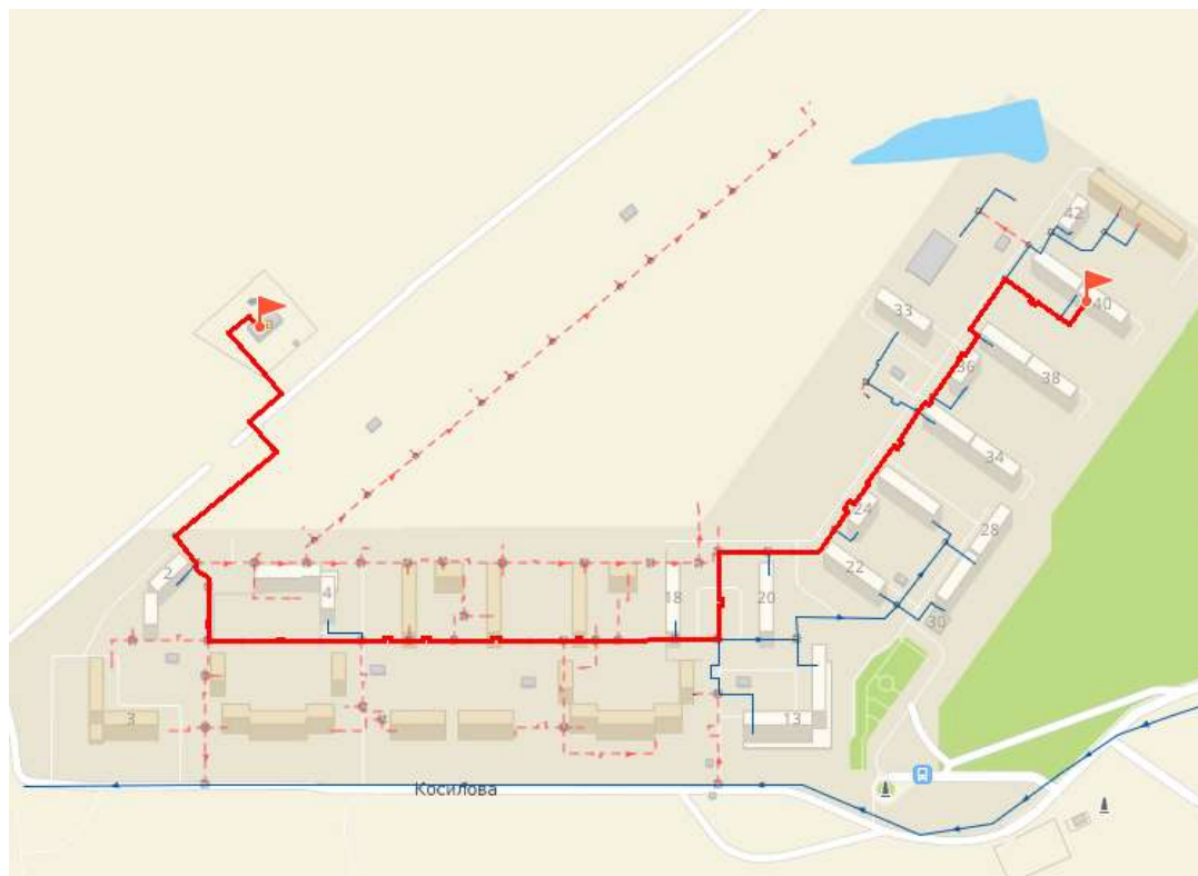
Рисунок 4.24 – Путь движения теплоносителя от источника тепловой энергии до конечного потребителя, в зоне действия Котельной кв. 24 (рисунок П46.1 МУ)
