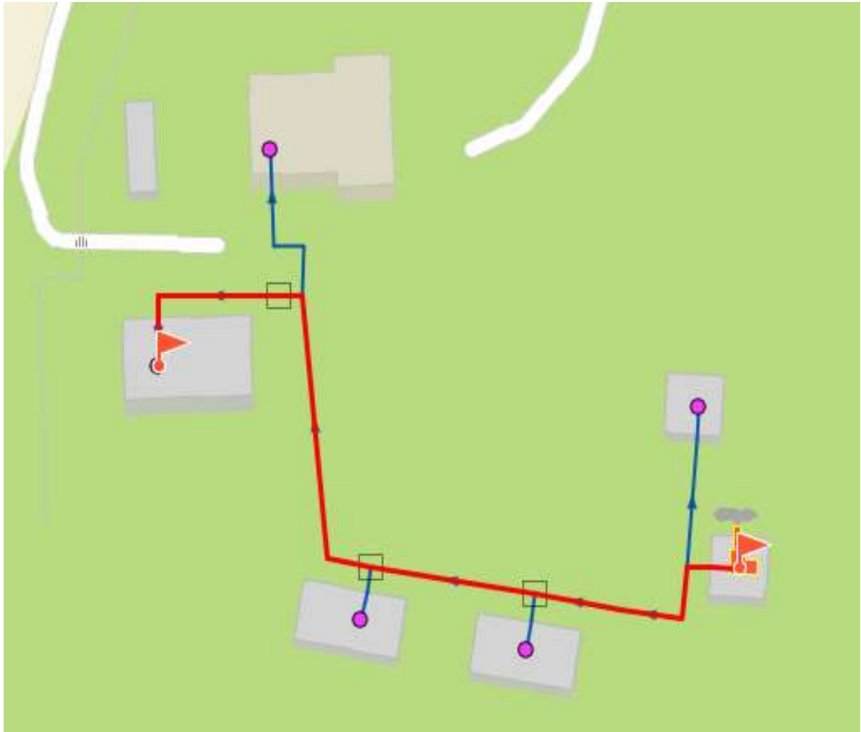
Рисунок 4.100 – Путь движения теплоносителя от источника тепловой энергии до конечного потребителя, в зоне действия котельной оздоровительного лагеря «Голубь» (рисунок П46.1 МУ)
