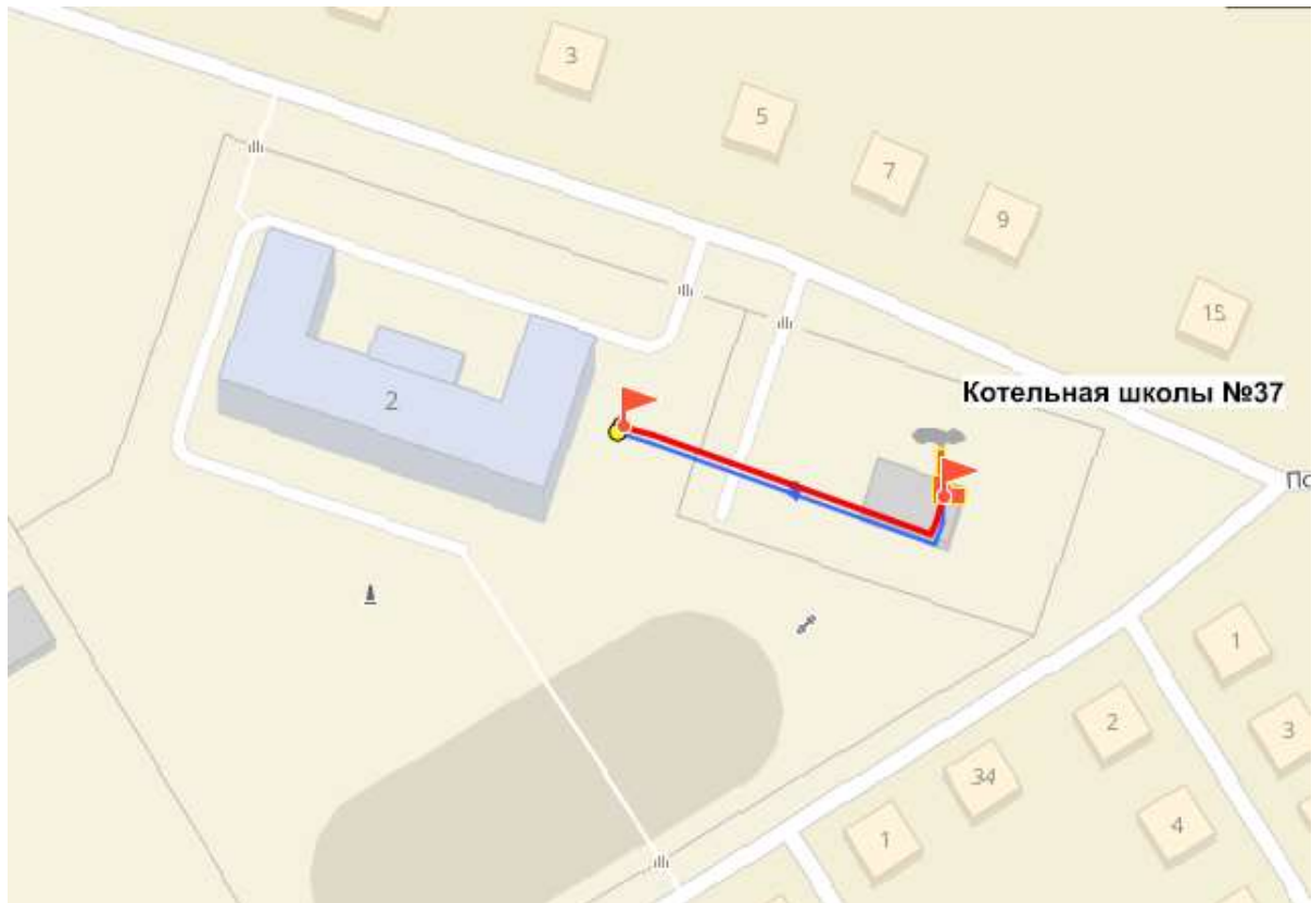
Рисунок 4.114 – Путь движения теплоносителя от источника тепловой энергии до конечного потребителя, в зоне действия котельной школы №37 (рисунок П46.1 МУ)
