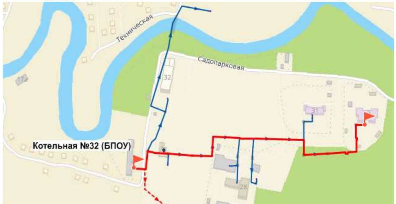
Рисунок 4.82 – Путь движения теплоносителя от источника тепловой энергии до конечного потребителя, в зоне действия котельной №32 (БПОУ) (рисунок П46.1 МУ)
