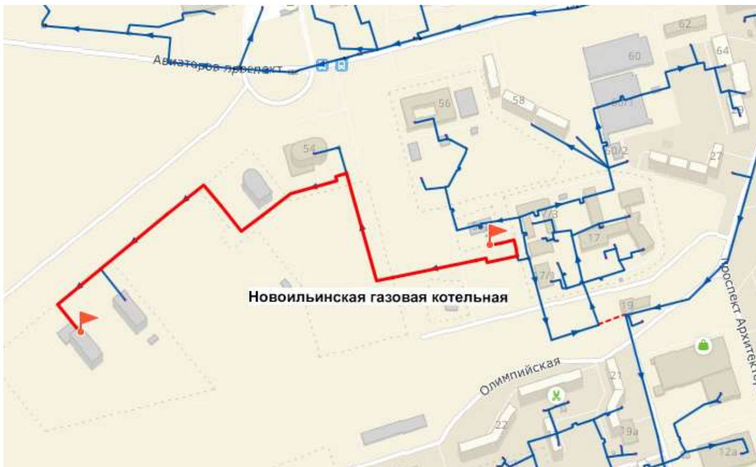
Рисунок 4.20 – Путь движения теплоносителя от источника тепловой энергии до конечного потребителя, в зоне действия Новоильинской газовой котельной (рисунок П46.1 МУ)
