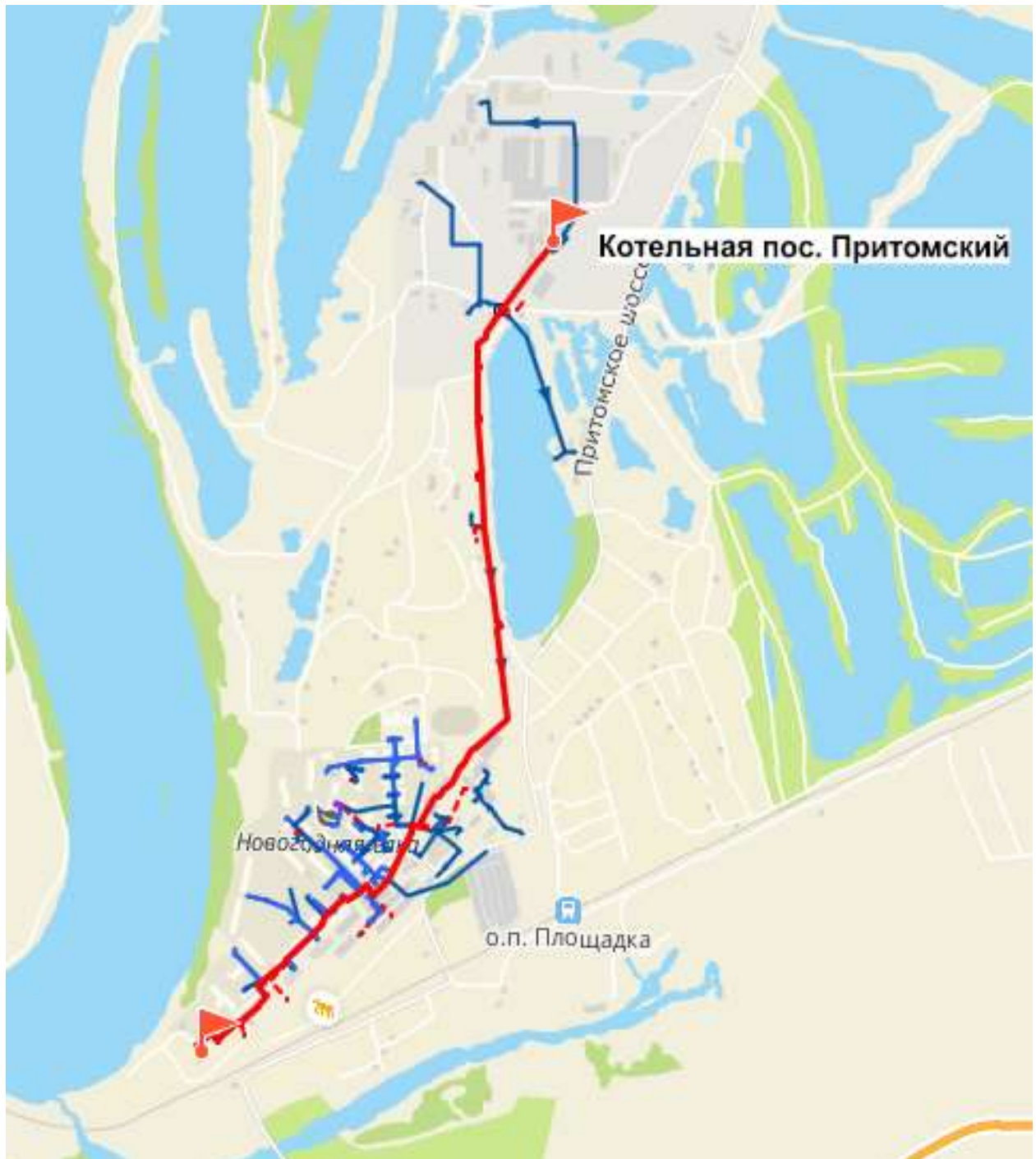
Рисунок 4.50 – Путь движения теплоносителя от источника тепловой энергии до конечного потребителя, в зоне действия котельной пос. Притомский (рисунок П46.1 МУ)
