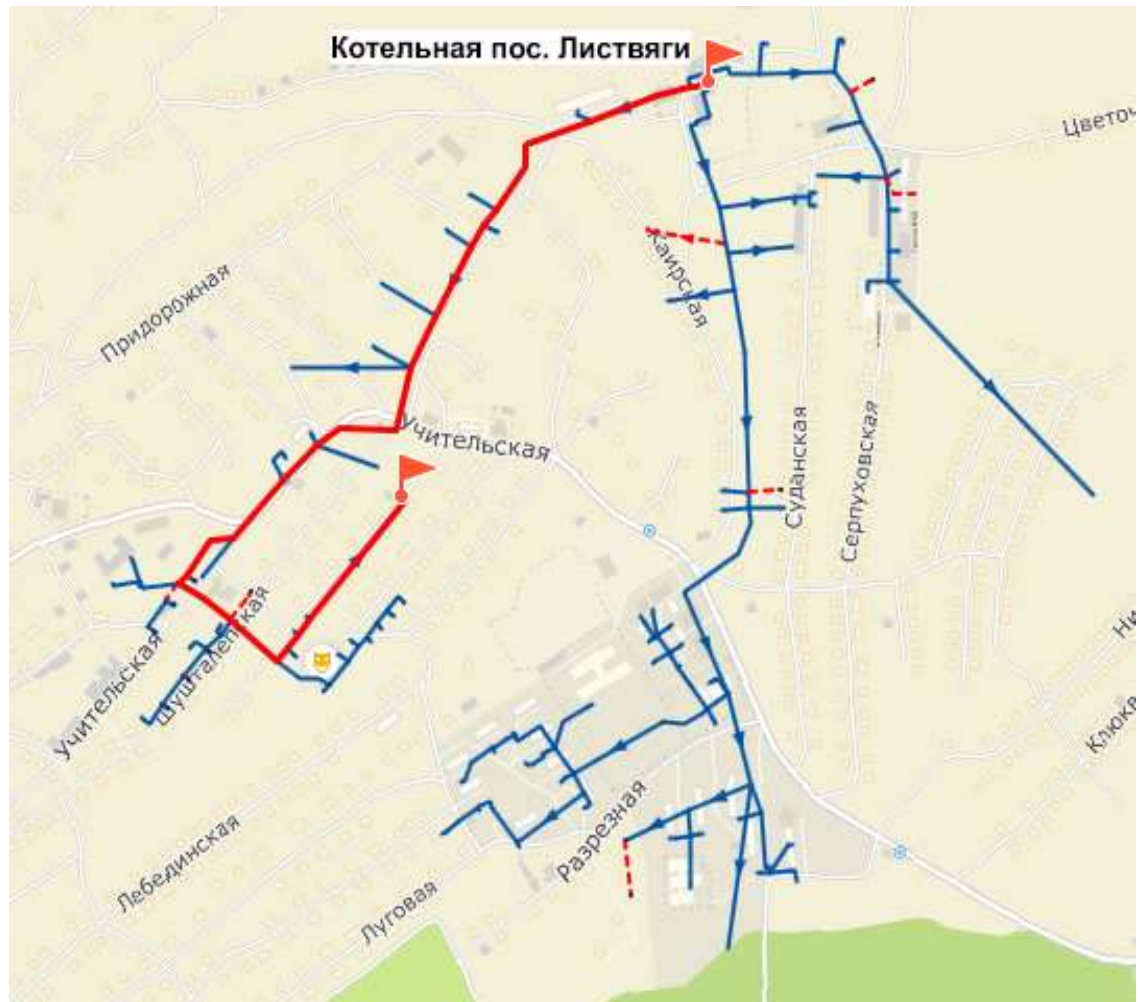
Рисунок 4.78 – Путь движения теплоносителя от источника тепловой энергии до конечного потребителя, в зоне действия котельной пос. Листвяги (рисунок П46.1 МУ)
