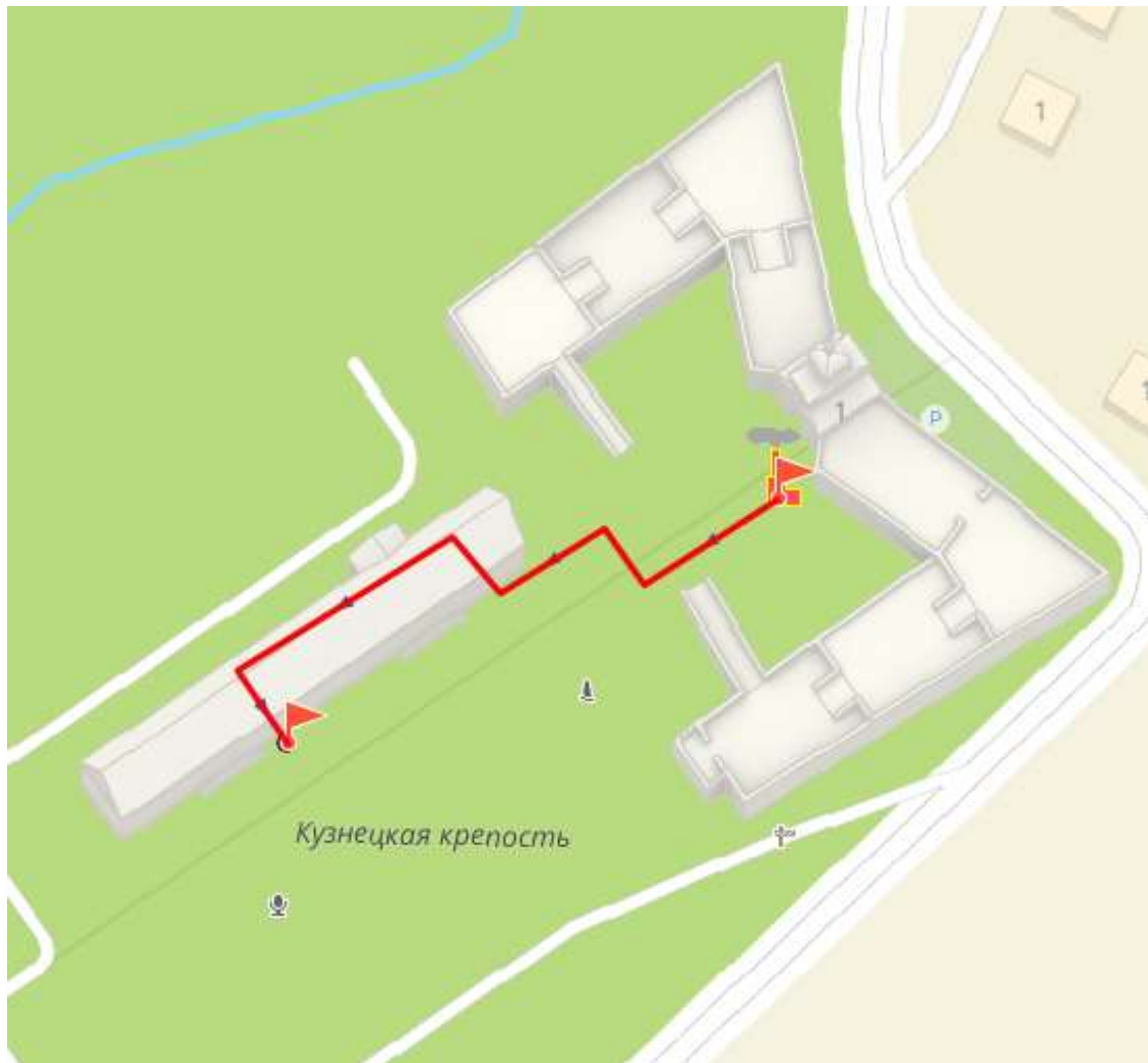
Рисунок 4.132 – Путь движения теплоносителя от источника тепловой энергии до конечного потребителя, в зоне действия котельной Кузнецкая крепость (рисунок П46.1 МУ)
