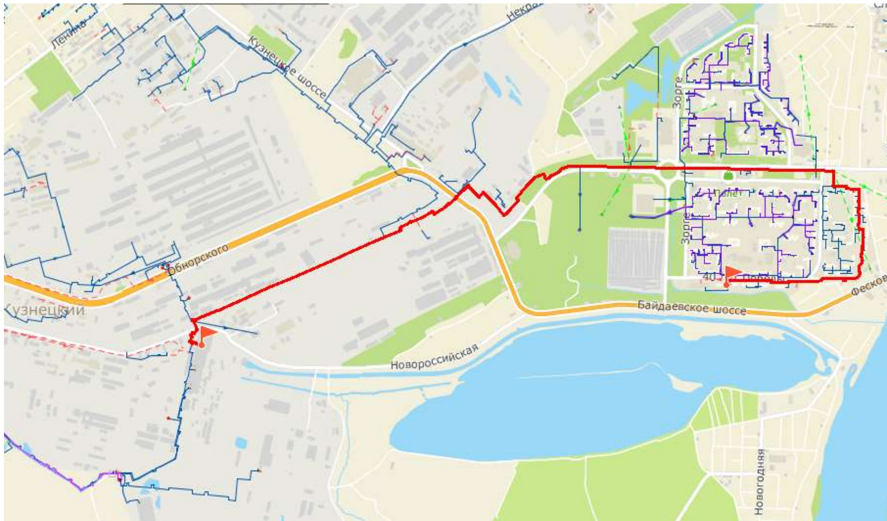
Рисунок 4.2 – Путь движения теплоносителя от источника тепловой энергии до конечного потребителя, в зоне действия КТЭЦ (Кузнецкий район) (рисунок П46.1 МУ)
