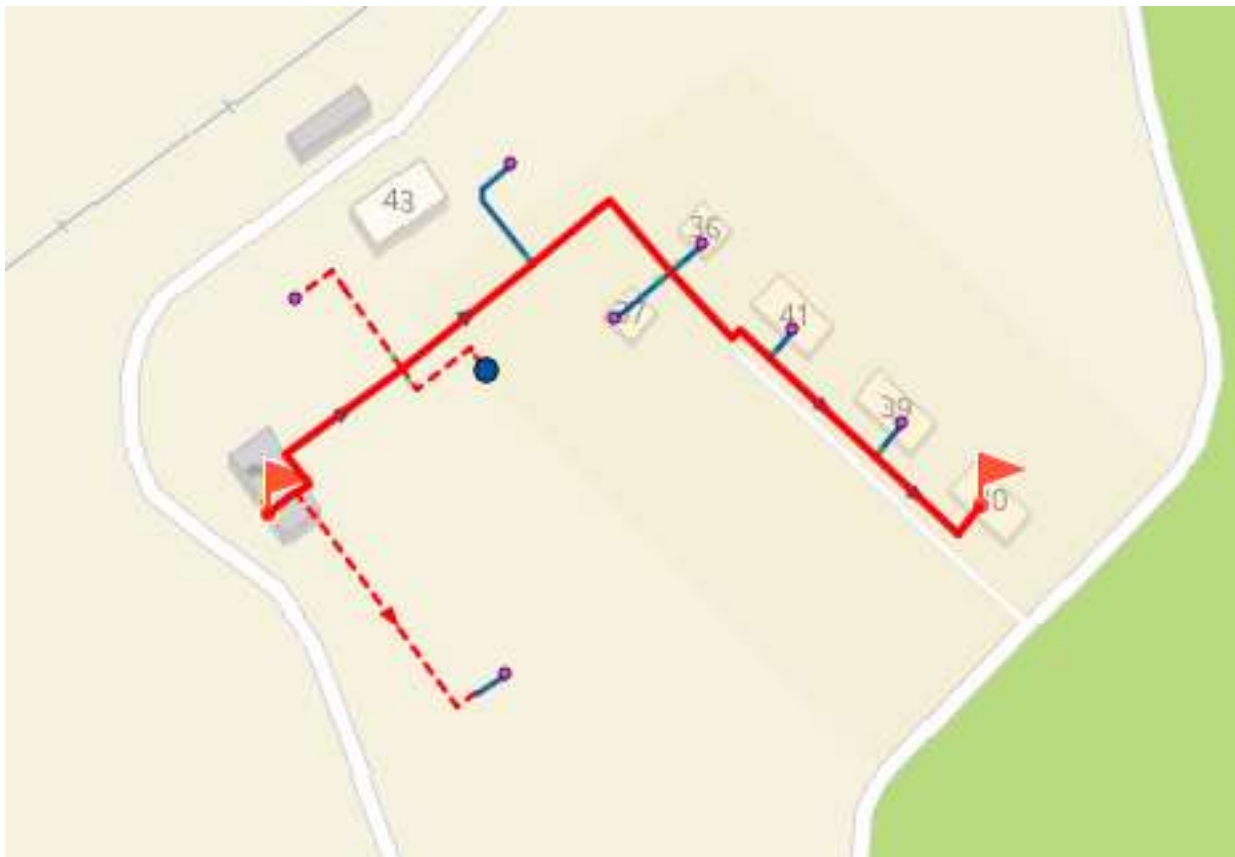
Рисунок 4.74 – Путь движения теплоносителя от источника тепловой энергии до конечного потребителя, в зоне действия котельной №3 п. Абагур-Лесной (рисунок П46.1 МУ)
