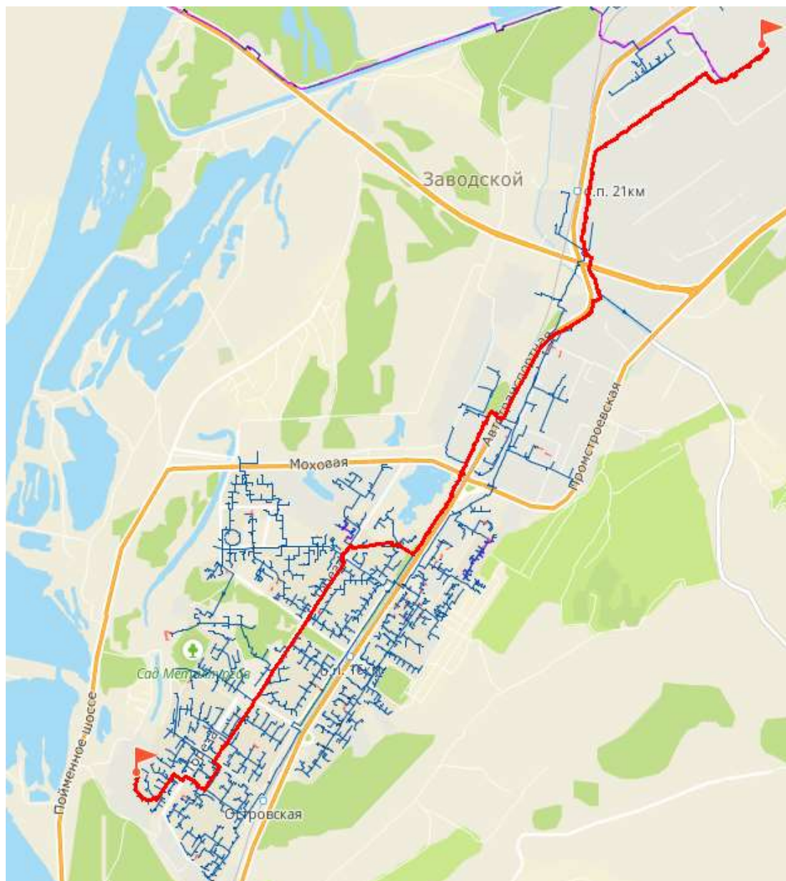
Рисунок 4.10 – Путь движения теплоносителя от источника тепловой энергии до конечного потребителя, в зоне действия ЗСТЭЦ Заводского района (наиболее удаленный потребитель) (рисунок П46.1 МУ)
