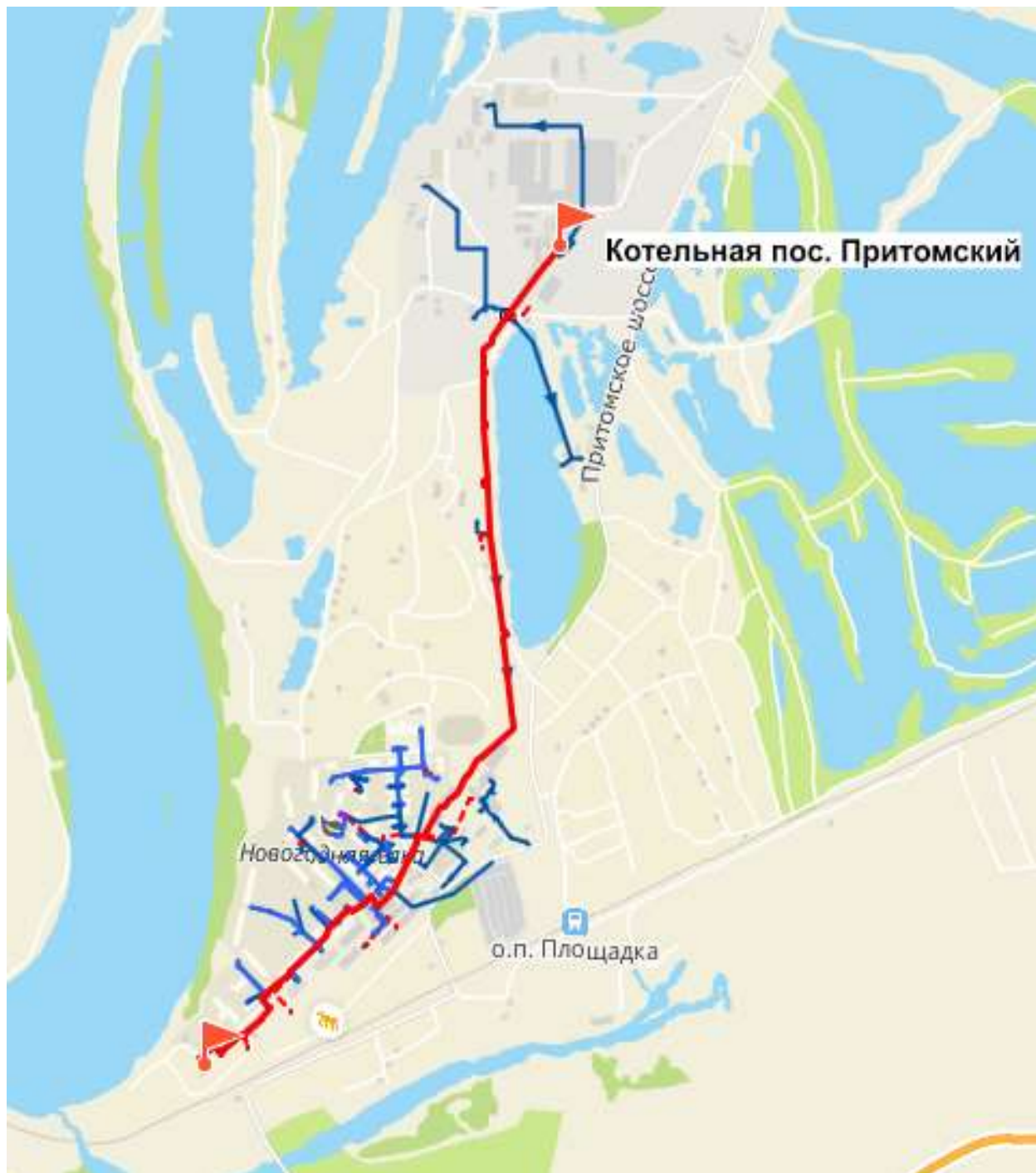
Рисунок 4.48 – Путь движения теплоносителя от источника тепловой энергии до конечного потребителя, в зоне действия котельной пос. Притомский (рисунок П46.1 МУ)
