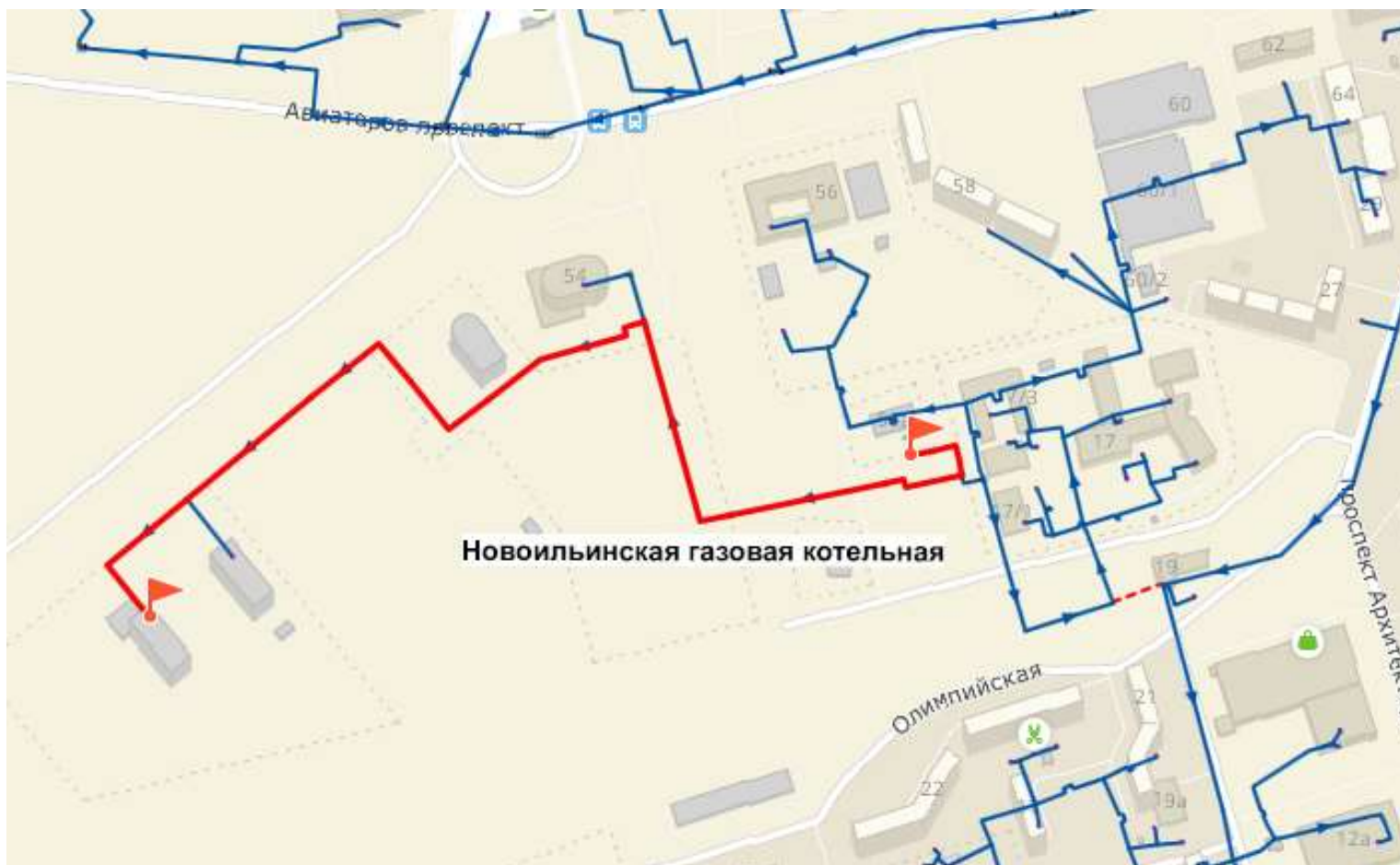
Рисунок 4.18 – Путь движения теплоносителя от источника тепловой энергии до конечного потребителя, в зоне действия Новоильинской газовой котельной (рисунок П46.1 МУ)
