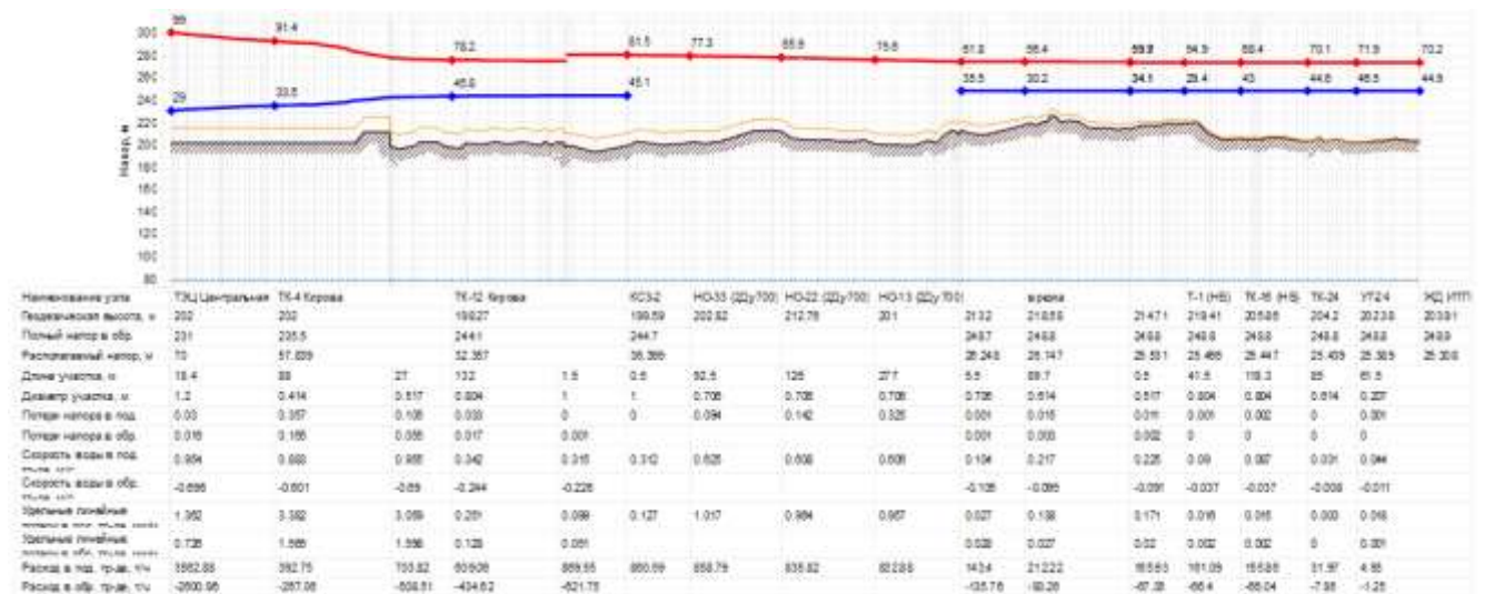
Рисунок 8.3 – Пьезометрический график при переключении потребителей Кузнецкой ТЭЦ на Центральную ТЭЦ в аварийном режиме
