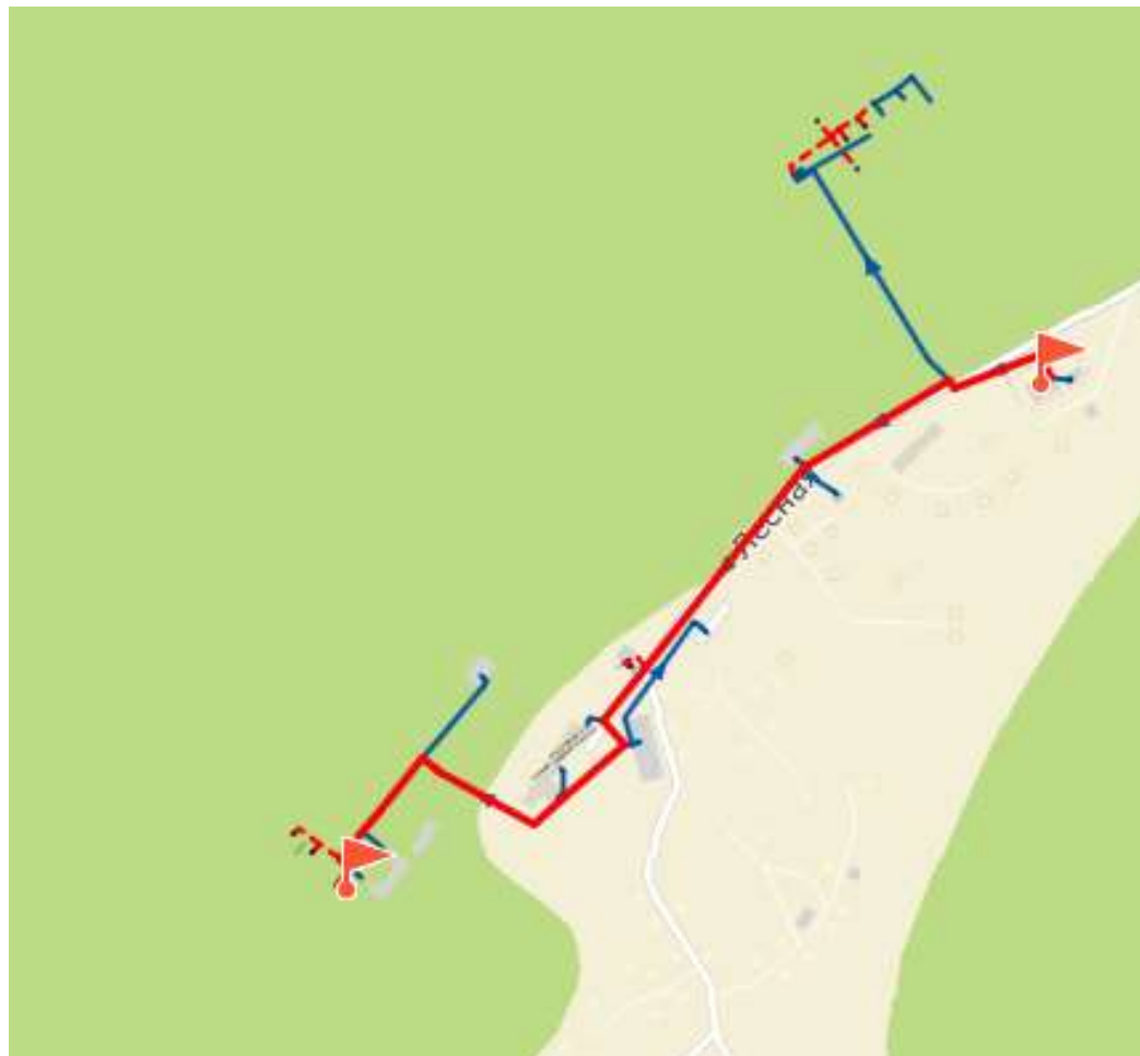
Рисунок 4.62 – Путь движения теплоносителя от источника тепловой энергии до конечного потребителя, в зоне действия котельной ОРК «Таргай» (рисунок П46.1 МУ)
