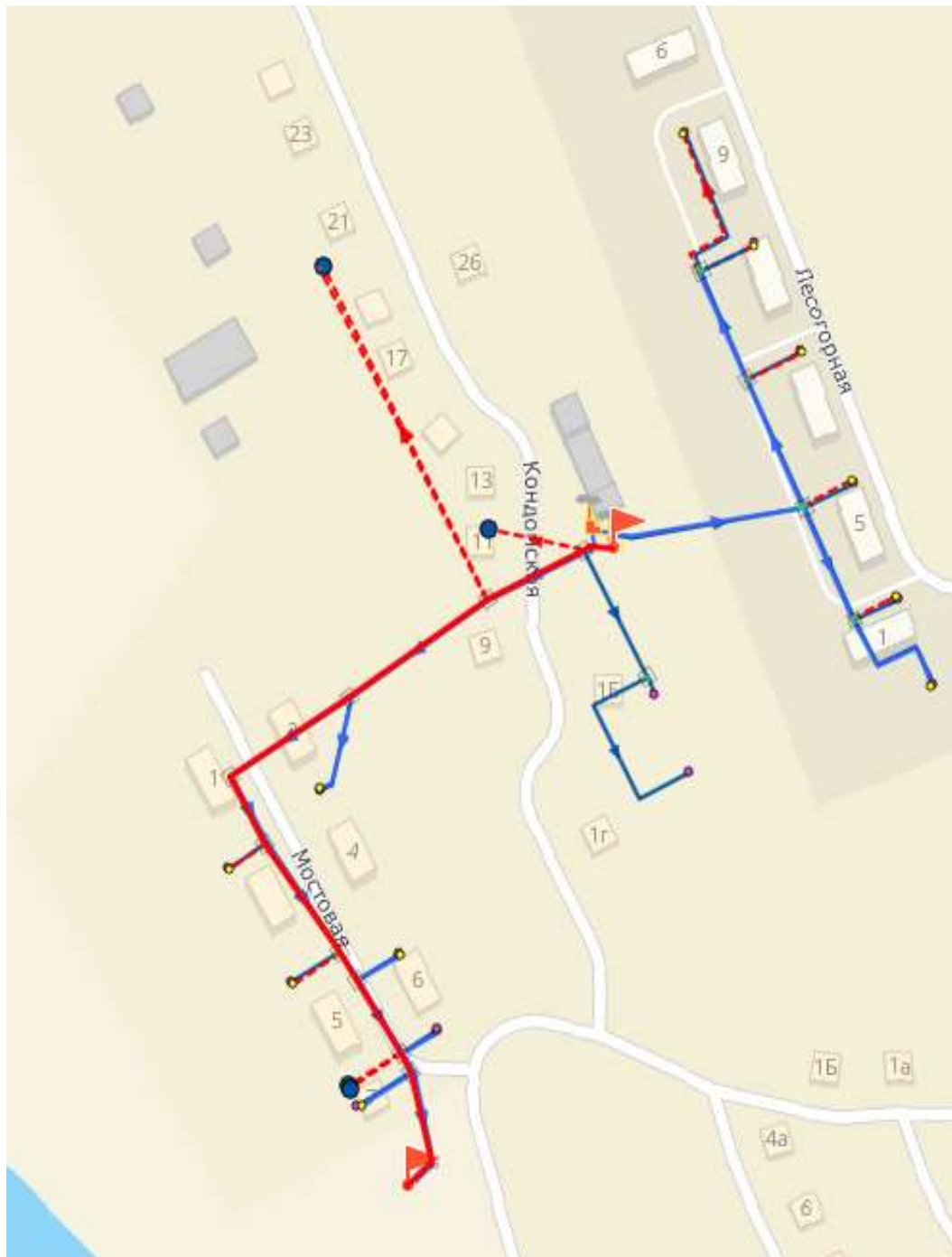
Рисунок 4.86 – Путь движения теплоносителя от источника тепловой энергии до конечного потребителя, в зоне действия котельной №1 п. Разъезд-Абагуровский (рисунок П46.1 МУ)
